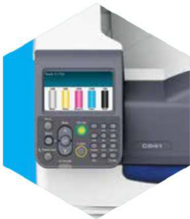
La pantalla LCD en color muestra el estado actual de la impresora; El indicador de tóner incorporado indica la vida útil restante de cada cartucho de tóner.
